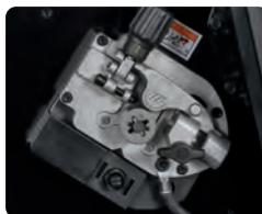
Прочный наклонный привод подачи проволоки с системой подающих роликов Quick Select™
