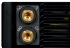
Два газовых фитинга обеспечивают возможность одновременного подключения к источнику двух сварочных горелок - для механизированной и аргонодуговой сварки - без дополнительных переключений.
