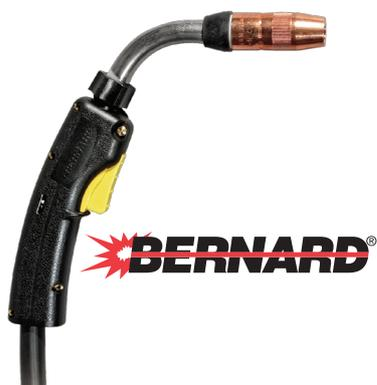
Сварочная горелка PipeWorx 300-15 с коническим наконечником и соплом рекомендуется специально для сварки корневого прохода при зафиксированном положении горелки, когда видимость ограничена. При смене наконечника и сопла на стандартное, с помощью данной горелки можно варить и заполняющие и облицовочные швы с использованием самозащитной проволоки или в режиме Pulsed MIG. Это позволяет не менять тип проволоки и состав защитного газа при переходе от корневого прохода к заполняющему и облицовочному.
