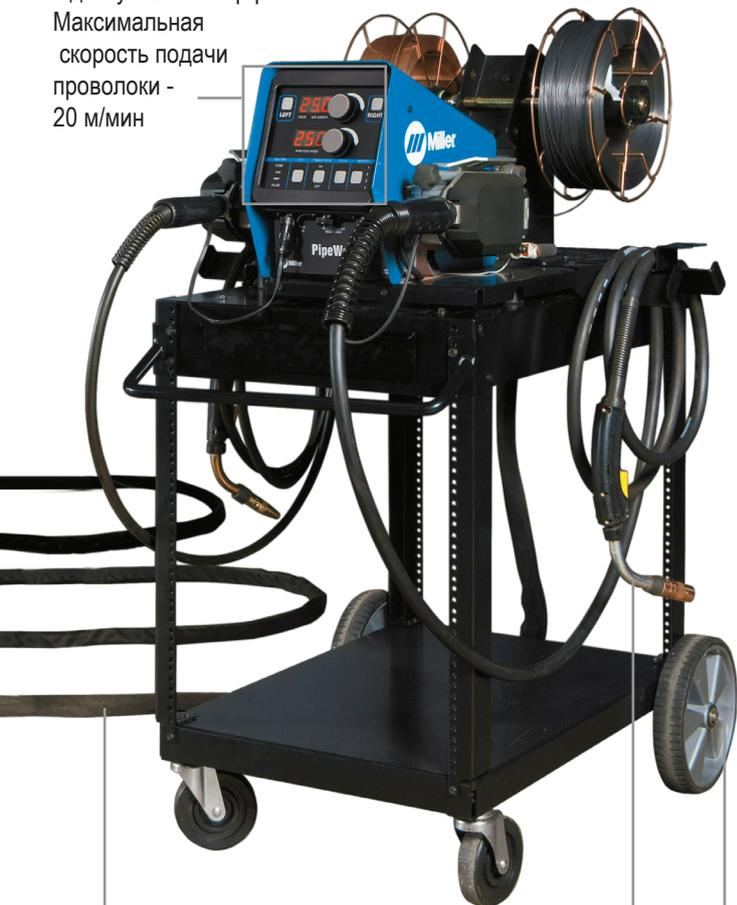
Специализированные сварочные горелки Bernard® PipeWorx guns для сварки труб
